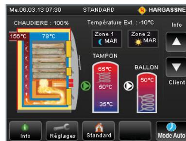
L'écran affiche une chaudière entièrement remplie et en plein fonctionnement. La chaudière et les ballons sont déjà chauds. Les circuits de chauffage fournissent de la chaleur dans l'ensemble de l'habitation.
