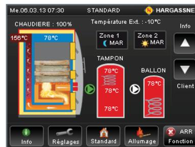
Le bois a été partiellement consommé. La chaudière et les ballons sont chauds. La chaudière fonctionne à puissance réduite. Les circuits de chauffage fournissent de la chaleur dans l'ensemble de l'habitation.
