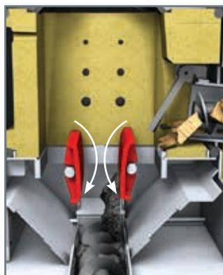
Lorsqu'elle est froide, la chaudière procède à un déchargement complet avant de démarrer : les **2 grilles s'ouvrent** et les cendres froides, ainsi que les corps étrangers (cailloux, clous, etc...), sont évacués dans la vis de déchargement.
