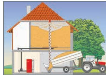
Remplissage d'un silo situé au 1<sup>er</sup> ou 2<sup>ème</sup> étage.
