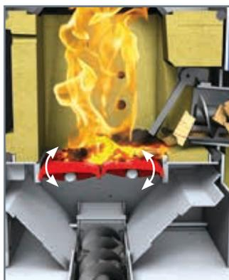
Pendant la combustion, les grilles sont **fermées**. Elles peuvent **osciller** légèrement pour homogénéiser la couche de braises et empêcher la formation des blocs de mâchefers.
