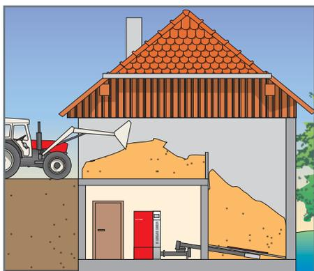
Silo au 1<sup>er</sup> étage à large accès avec remplissage direct.
